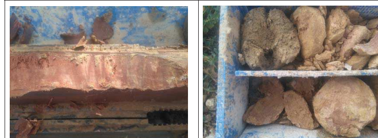
Aspecte de l'argil·lita extreta del sondeig S-6.
